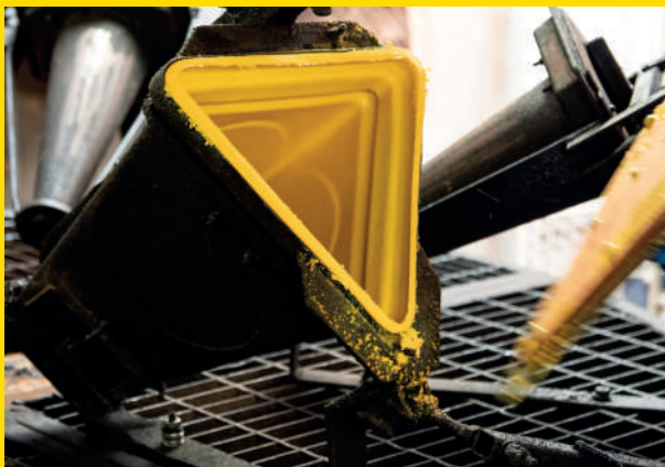
Cône Mk™4 'stationnement interdit' prêt à être retiré de son moule à injection rotatif.
